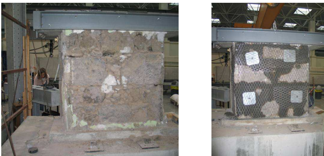
Figura 29 – Reforço de paredes de alvenaria com malhas de aço inox [16]
