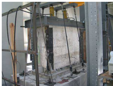
b) Ensaio em laboratório numa parede de alvenaria proveniente dos Açores
