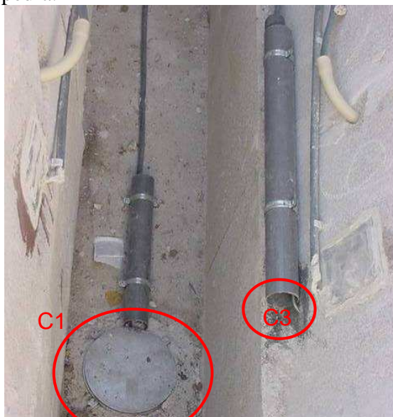
Figura 47 - Células de pressão total: C1 (circular) e C3 (meia-lua)
