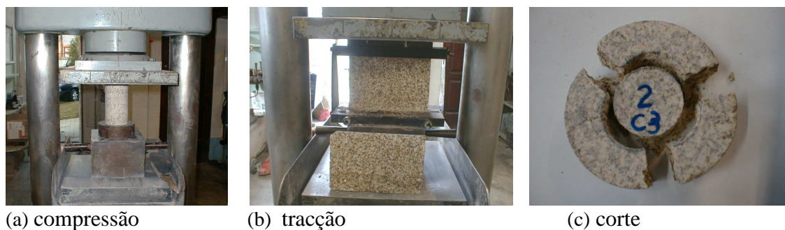
Figura 7 - Ensaio sobre carotes de pedra
