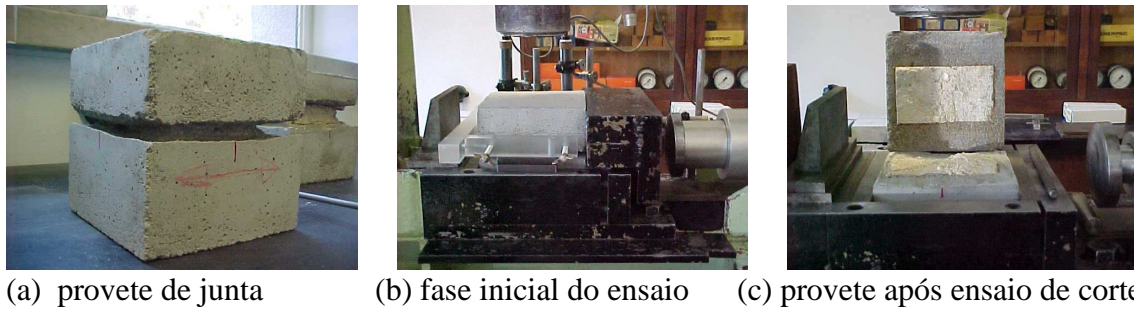
Figura 8 - Ensaio de caracterização das junta
