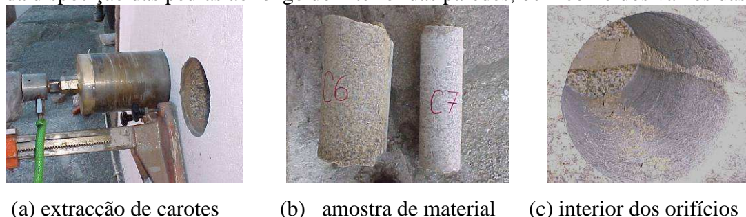
Figura 6 – Extracção de carotes na Igreja do Mosteiro da Serra do Pilar
