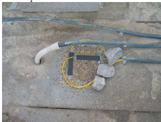
Figura 45 - Extensómetros de base óptica. Instalação.
