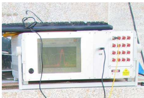
Figura 52 - Sistema de interrogação para sensores de fibras ópticas.
