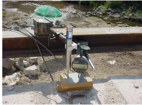
Figura 35b- Descimbre de um arco. Comparador digital e LVDT no coroamento do arco.
