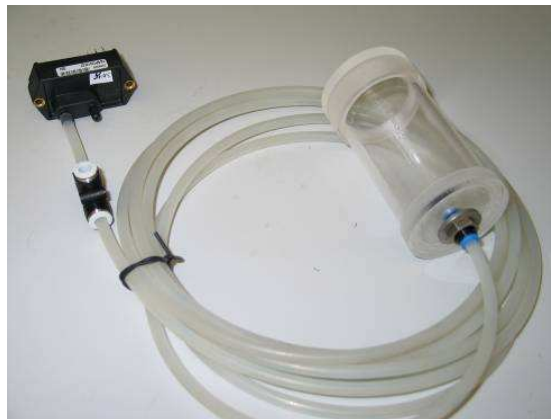
Figura 36 - Sensor de pressão, respectivo tubo e reservatório para medição de desníveis.
